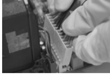
Figura 5.10: Seqüência do encaixe da fonte AT na placa-mãe.
