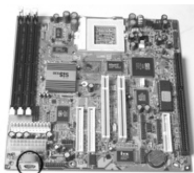
Figura 6.8: Placa-mãe com conector din.
