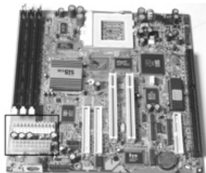
Figura 6.11: Placa-mãe com conector AT e ATX.
