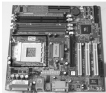
Figura 6.13: Placa-mãe com slot para processador.
