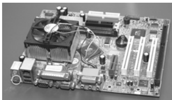
Figura 6.7: Placa-mãe com conector mini-din.
