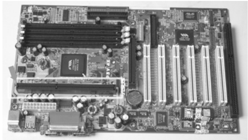
Figura 7.4: Slot do processador Pentium II.
