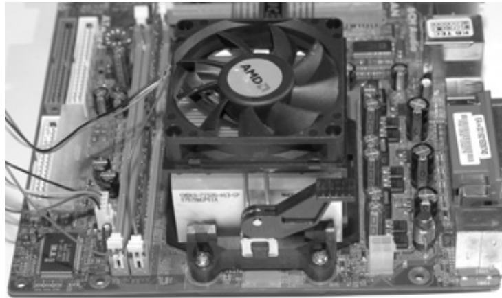
Figura 7.2: Processador tipo Socket instalado na placa-mãe.
