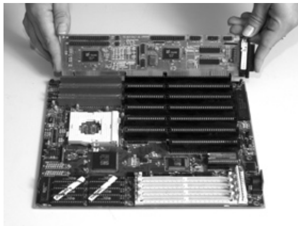
Figura 9.6: Placa de expansão sendo encaixada em slot VLB.
