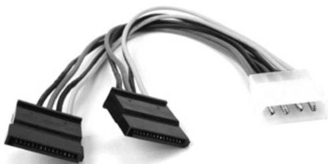
Figura 11.9: Adaptador de HDs SATA para fonte de alimentação. Fonte: http://www.sxc.hu/photo/486920
