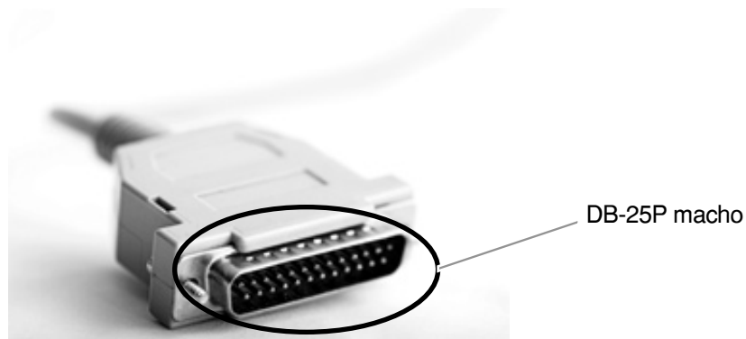
Figura 11.12: Conector do cabo da impressora paralela. Fonte: http://www.sxc.hu/photo/390557
