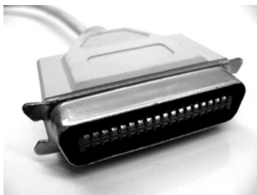
Figura 11.13: Conector de 36 pinos que é ligado à impressora. Fonte: http://www.sxc.hu/photo/461054
